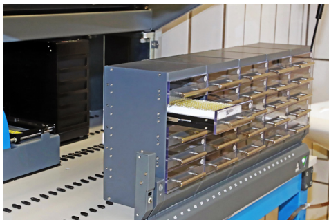
Abbildung 129 Vorne: Spezialanfertigung Hotel (LH Instruments) mit fünf voll Auszügen (mit Teleskopschiene) zur Beladung mit je einer Mikrotiterplatte, optisch integriert in geteilter Frontscheibe, Hotel bündig abschließend mit Frontscheibe, Auszugsfronten aus UV-C Lampe geeignetem Glas
